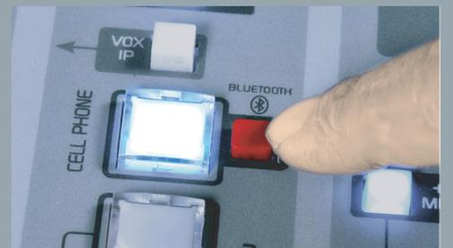
La línea para teléfono celular se maneja sin cables por Bluetooth con conexión de audio digital a la consola logrando un excelente sonido al aire.
